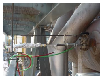
赤印のガラス機器でダイオキシン、黄印の機器で、排ガス中のダスト量を測定しています。
