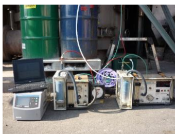
上図の装置類を用いて、工場稼働中の排ガス物質のモニタリング・測定を行います。
