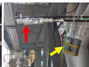
奥・赤印のガラス機器でダイオキシンを、手前・黄印のガラス機器で SOx を測定しています。
