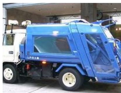
古くなった収集車を改造して生まれ変わったスケルトンごみ収集車。
