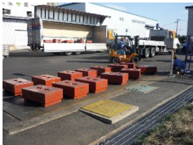
分銅による荷重検査です。トラックスケールに定められた重さのおもりを乗せていきます。
