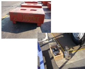
分銅は、1000kg のものばかりでなく、10kg 単位の小さなものもありました。
