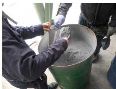
排ガス測定後、分析用ダストを採取します。
