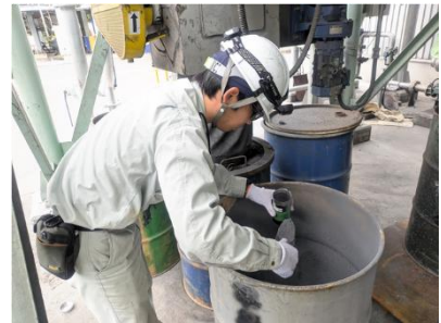
排ガス測定後の分析するためのダストを採取します。
