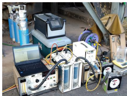
排ガス物質のモニタリングおよび測定を行います
