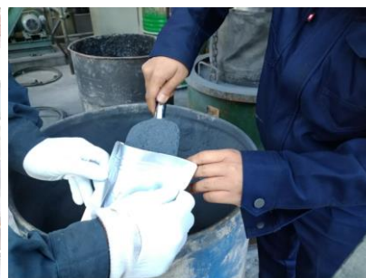
排ガス測定終了後の分析用ダストを採取しています
