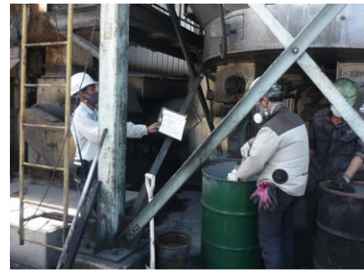
排ガス測定後の分析用ガストを採取しています。
