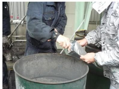
排ガス測定の終了後に分析用ダストを採取します。
