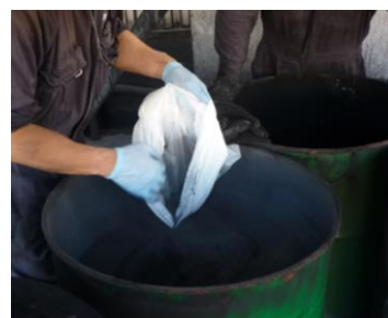
排ガス測定終了後、ばいじんを採取して分析いたします。
