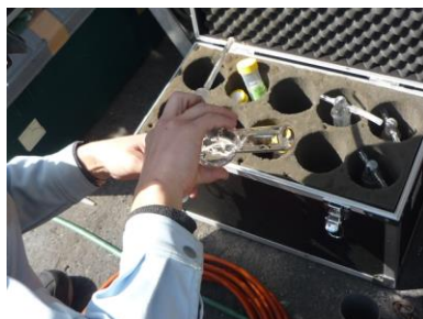
分析用の排ガス物質を採取しています。
