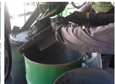
排ガス測定の後、ばいじんを採取して分析いたします。
