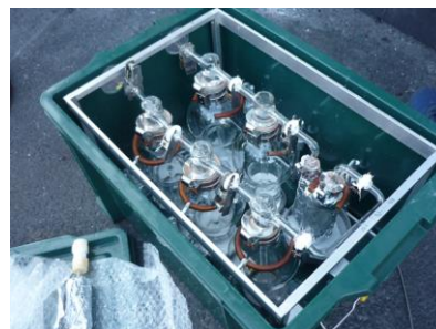
排ガス物質を収集して分析します。
