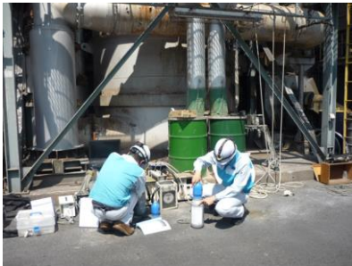
測定機器の設置および使用するガスの確認をしています。
