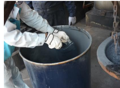
排ガス測定後のばいじんを採取して分析します。
