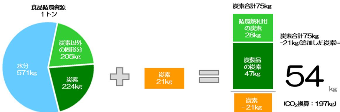
食品循環資源 1 トンには 571kg の水分、224kg の炭素、205kg の炭素以外の固形分が含まれています。一般的には食品循環資源の水分は 70%程度ですが、お客様の食品循環資源の性質を事前に調査・分析し、水分の低い食品循環資源を混ぜることによって水分率を調整し、エネルギー効率を高めるようにしています。
