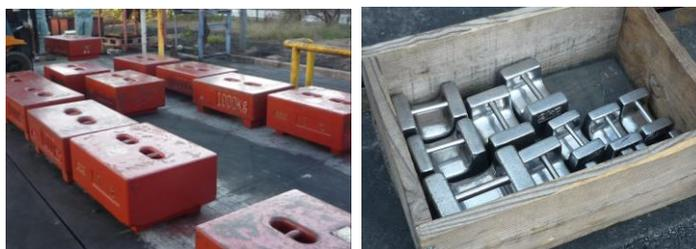
大小さまざまな銅を用いて荷重検査を行った後、計量器にトラックを載せて重量確認と点検を行います。
