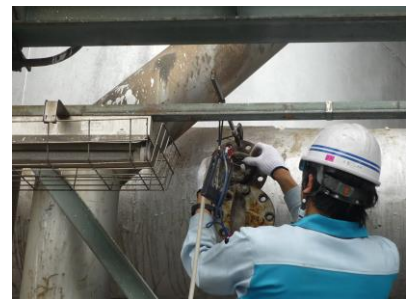
測定前に排ガスの流量を計測しています。
