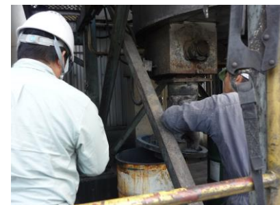
排ガス測定後にダストを回収し、分析にかけます。
