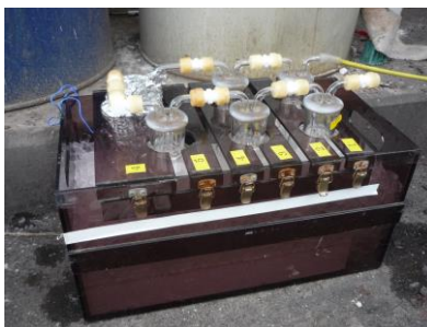
排ガス物質の測定装置。
