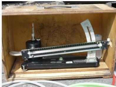
排ガス測定の前準備として経路内の流量を計測します。
