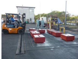
分銅による荷重検査を行っています。
