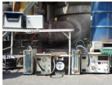
排ガス物質の測定装置
