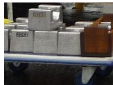
500kg、1,000kg のほかに、単位の小さな分銅も使用して微調整を行います。
