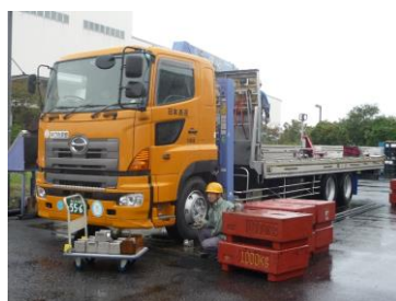
分銅での検査後、実際にトラックを乗せて点検、重量確認を行います。
