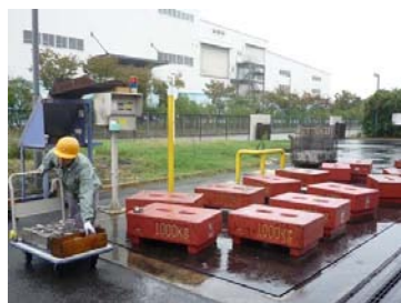
分銅による荷重検査の様子です。トラックスケールに定められた重さのおもりを乗せていきます。
